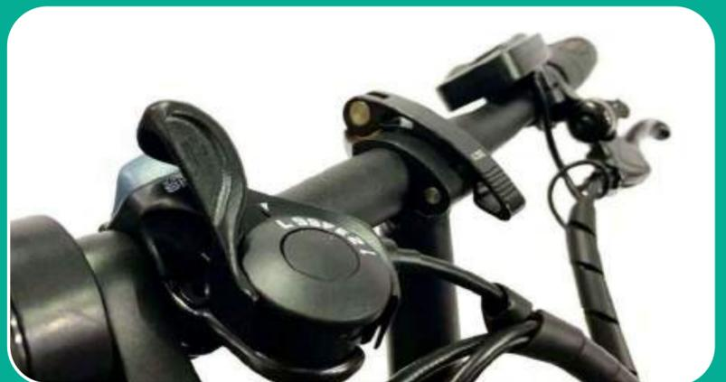
4. Coloque y apriete la junta y la tuerca. Ajuste el ángulo del manillar y cierre la palanca de leva para finalizar.
