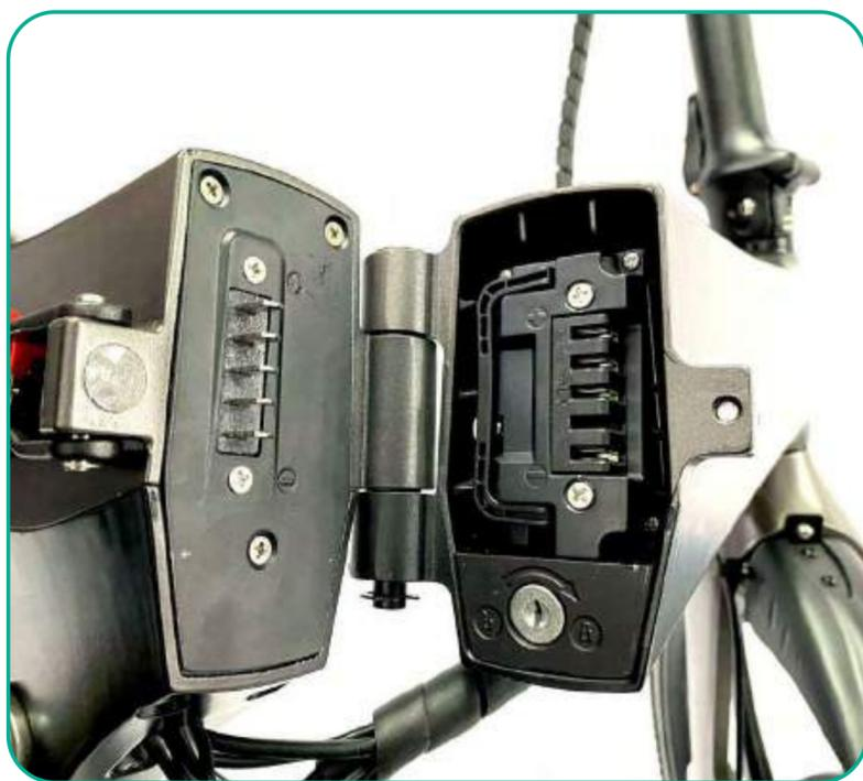
4. Para instalar la batería introdúzcala, bloquéela con la llave y saque la llave. Guarde la manivela de la batería y pliegue la bici. **No olvide bloquearla.**
