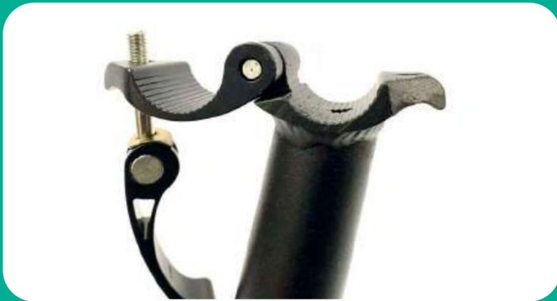
1. Despliegue el soporte del manillar, suelte la palanca de leva y desatornille en el sentido de las agujas del reloj.
