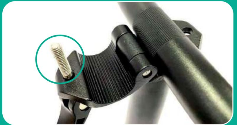
2. Aparte la tuerca y la junta. Abra el soporte pero deje el tornillo de la palanca de leva adentro.
