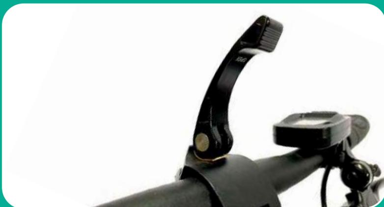
3. Coloque el manillar sobre el soporte como se muestra en la foto, cierre el soporte y pase el tornillo.
