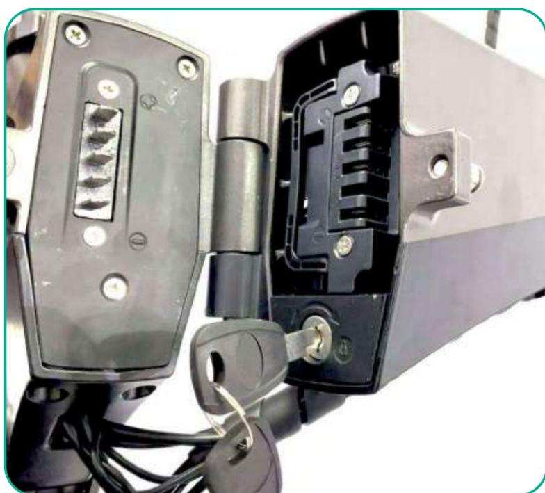
2. Despliegue el cuadro y desbloquee la batería utilizando la llave.
